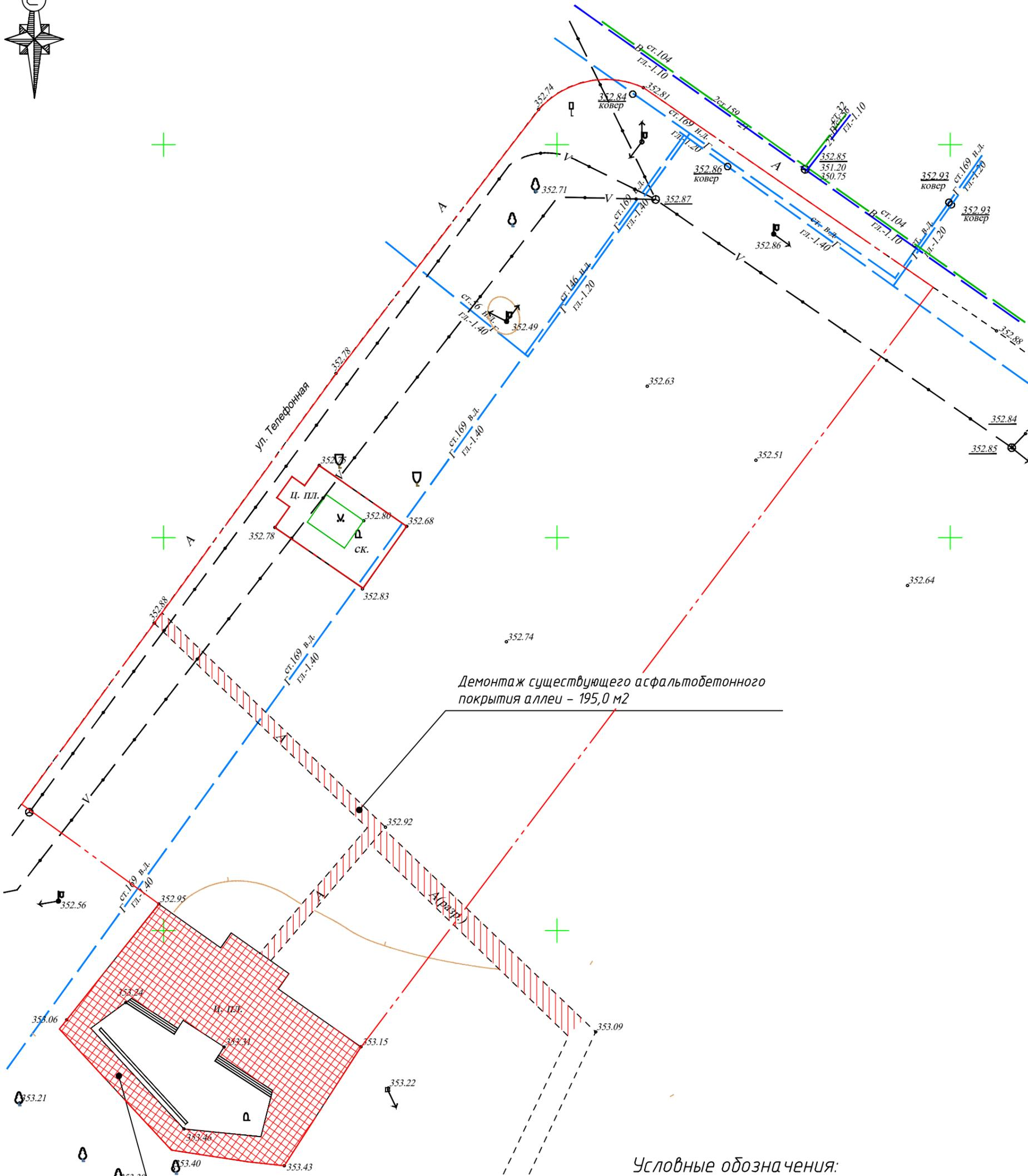
Демонтаж существующего асфальтобетонного покрытия аллеи – 195,0 м<sup>2</sup>
